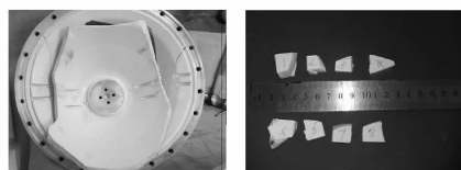
(c) 3XA090507-138盆式绝缘子取样部位及试样尺寸
